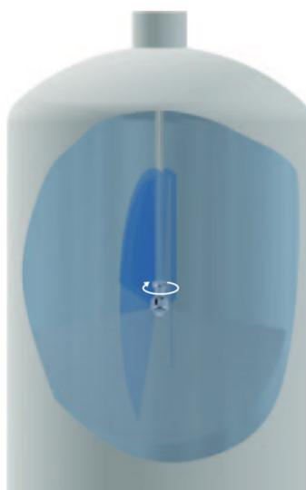
**Wichtig:** Düse kann kurzfristig mit Druckluft getrocknet werden. Für ein optimales Reinigungsergebnis und Gewährleistung der Standzeit Düse nur im angegebenen Druckbereich verwenden.
